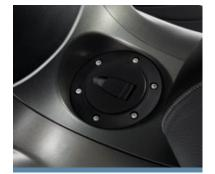
PRACTICAL FUEL CAP POSITIONED IN THE TUNNEL
